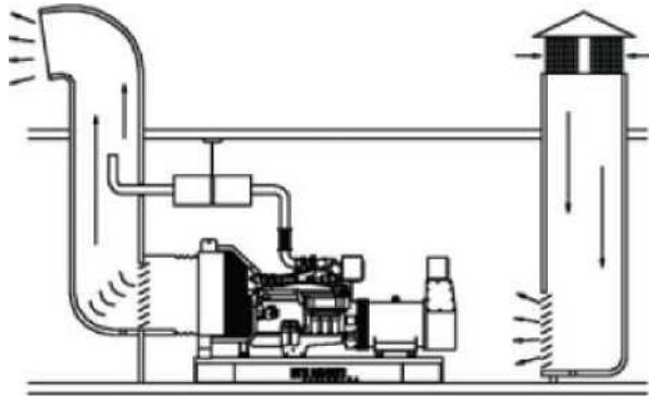
**Рис. 5.2.** Направление воздуха от радиатора отклоняющими лопастями
