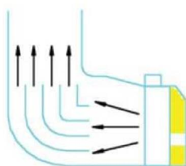
**Рис. 5.2.** Направление воздуха от радиатора отклоняющими лопастями
