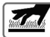
! Избегайте попадания горячего масла, горячей охлаждающей жидкости, горячих выхлопных газов и соприкосновения с горячими поверхностями и острыми краями и углами.
