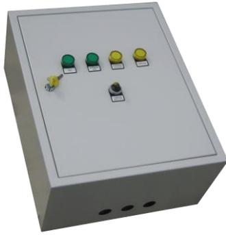
Система автоматического ввода резерва предназначена для автоматического управления подключением нескольких источников электропитания к нагрузке. Следит за качеством напряжения основной сети, выдает сигнал на запуск ГУ и управляет контакторами. Включает в силовые контакторы подключения различных источников к нагрузке, зарядное устройство аккумуляторной батареи от сети, устройства защитного отключения, средства индикации и мониторинга. В состав системы (М) также входит модуль контроля напряжения.
