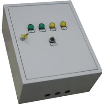
Система автоматического ввода резерва предназначена для автоматического управления подключением нескольких источников электропитания к нагрузке. Следит за качеством напряжения основной сети, выдает сигнал на запуск ГУ и управляет контакторами. Включает в силовые контакторы подключения различных источников к нагрузке, зарядное устройство аккумуляторной батареи от сети, устройства защитного отключения, средства индикации и мониторинга. В состав системы (M) также входит модуль контроля напряжения.
